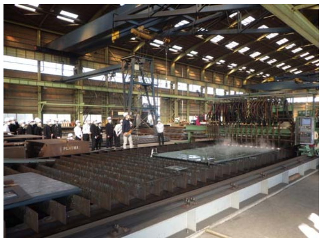
鋼板工場でのガス溶断の様子
