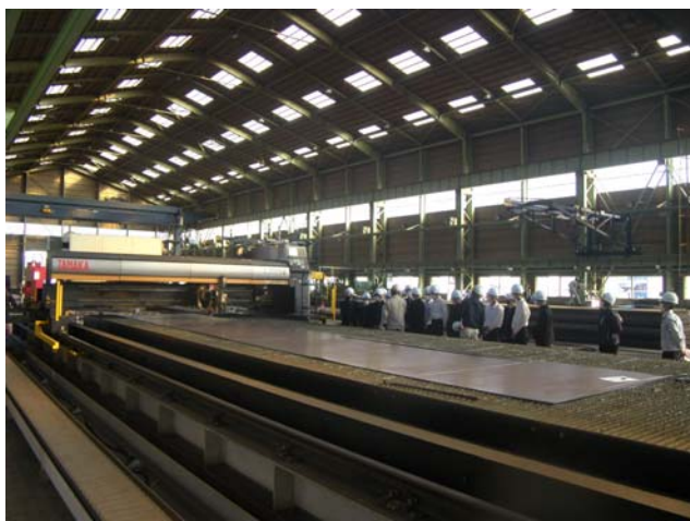
鋼板工場でのレーザー溶断の様子
